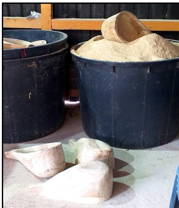
Slika 2.1.1.4.: Sušenje kutli za šargije u stočnom brašnu. (autor)
