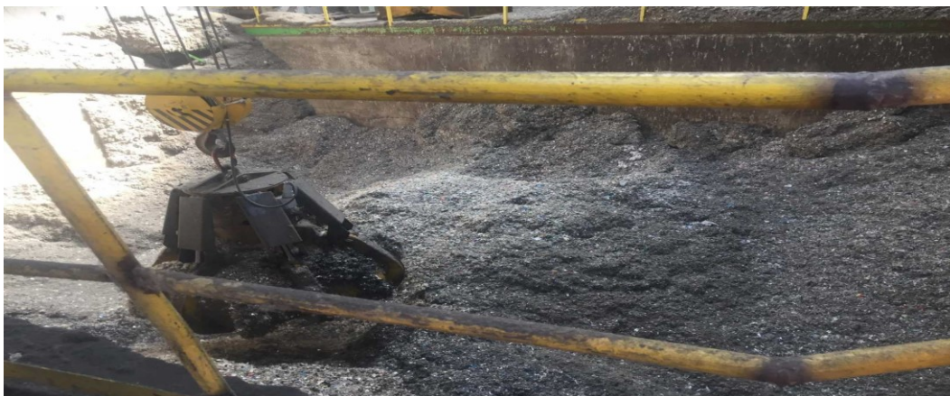
Slika 12: Proizvod nakon termičke obrade spaljivanja, SAKO Brno ( Autor, 2022 godina).
