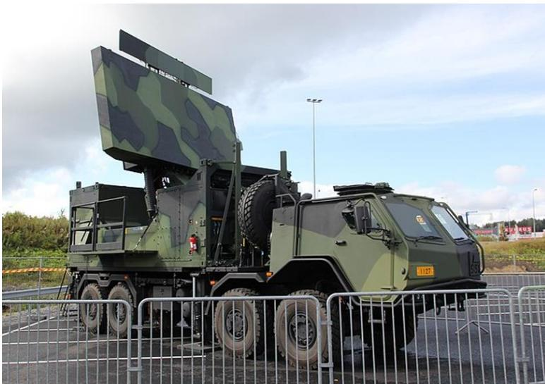
Slika 4. Mobilna verzija sistema GM 400 (Oružane snage Finske)
